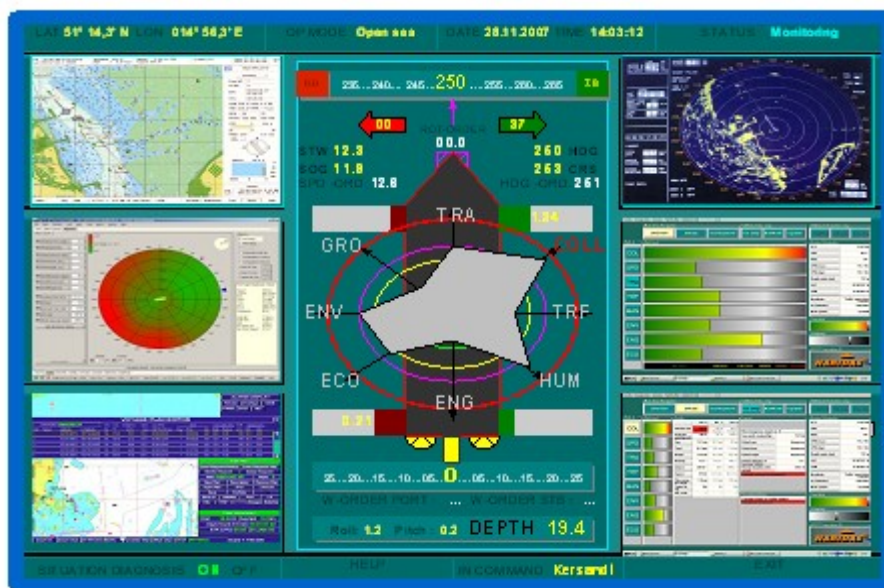
Beispiel für ein Conning-Display nach KERSANDT auf der Grundlage des AIT – Lösungsansatzes
