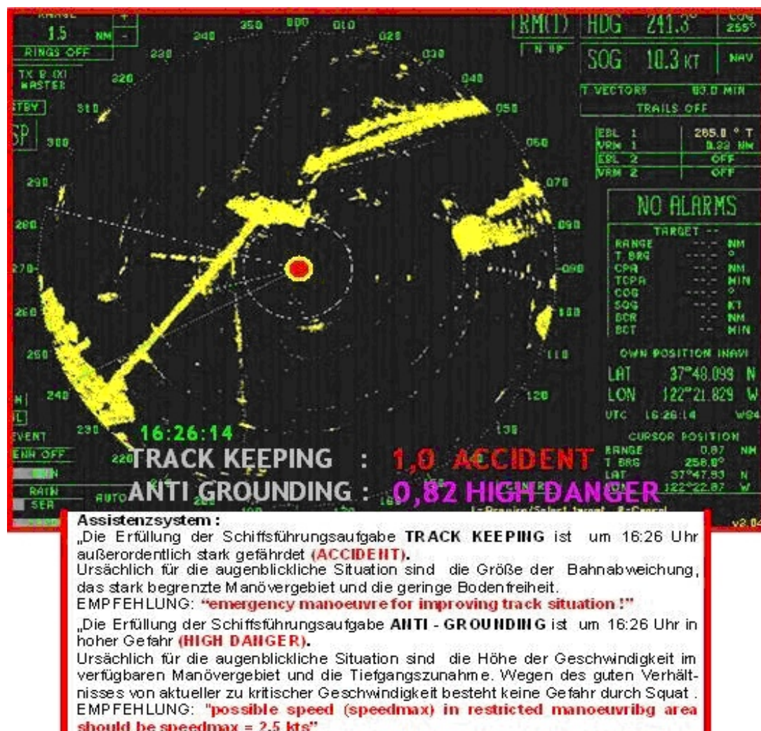
Bild 8 : 16:26:14 Uhr - Wirkungsvolle handlungsregulierende Informationen für den Lotsen / Kapitän und Ursachendarstellung durch das Assistenzsystem (vergl. / 9 / )
