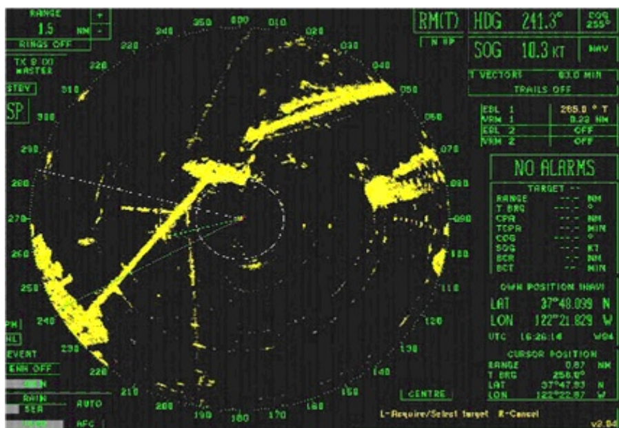
Bild 3: 16:26:14 Das Racon-Signal erscheint klar und deutlich. Der Lotse wird sofort aktiv !
